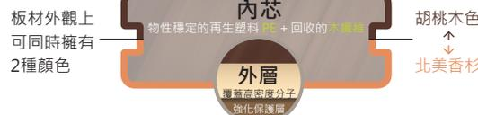
外保護層與內芯層均採用共擠成型技術，無需擔心表層剝落分離，同時提高了結構強度。
